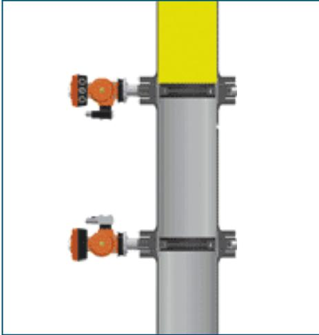
El medio se encuentra en el proceso y está bloqueado en el lado de entrada. Por razones de seguridad, la válvula de salida se abre antes de cada ciclo individual, de modo que el material restante cae del tubo de llenado.
