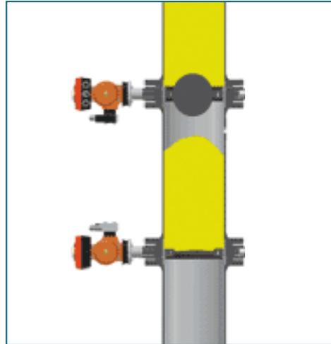
El medio cae en el tubo de llenado y se mantiene en el lado de la salida. El tiempo de llenado se puede ajustar libremente. Con la ayuda de un sensor de nivel de llenado se puede interrumpir el proceso de llenado según las necesidades.
