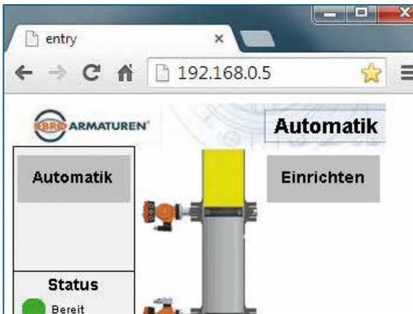
La pantalla principal sirve para la supervisión sencilla del proceso en marcha y para la selección de los modos de funcionamiento.
