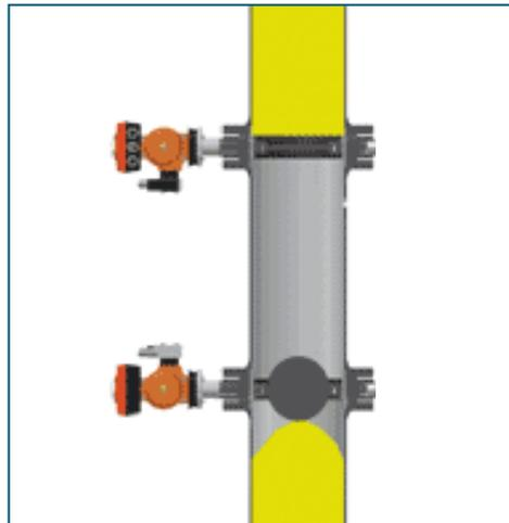
Para el vaciado se abre la válvula de cierre de lado de la salida, de forma que el medio es conducido al proceso posterior.
