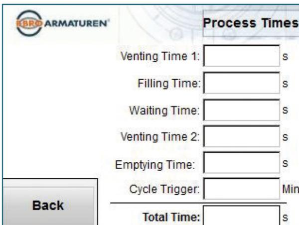
En el área de menú «Tiempos de proceso», la secuencia de ciclos se puede adaptar de forma flexible al proceso.
