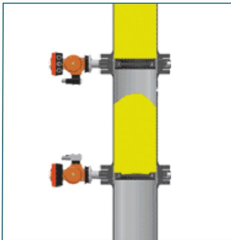
Después de alcanzar el nivel de llenado, la válvula de entrada se cierra. El medio se mantiene en el tubo de llenado hasta la descarga. El volumen de carga/descarga por ciclo depende del medio, la presión y la altura constructiva de la unidad completa.
