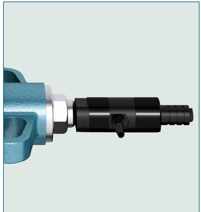
El vibrador lleva el disco a la horizontal en una vibración lineal. La frecuencia de la vibración es controlada mediante la presión de aire.
