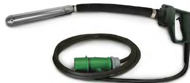
Consolidaciones del hormigón
